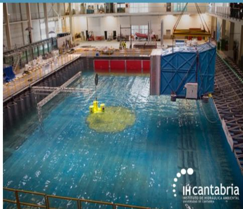
1er ensayo tridimensional de oleaje de interacción ola/corriente con vegetación
